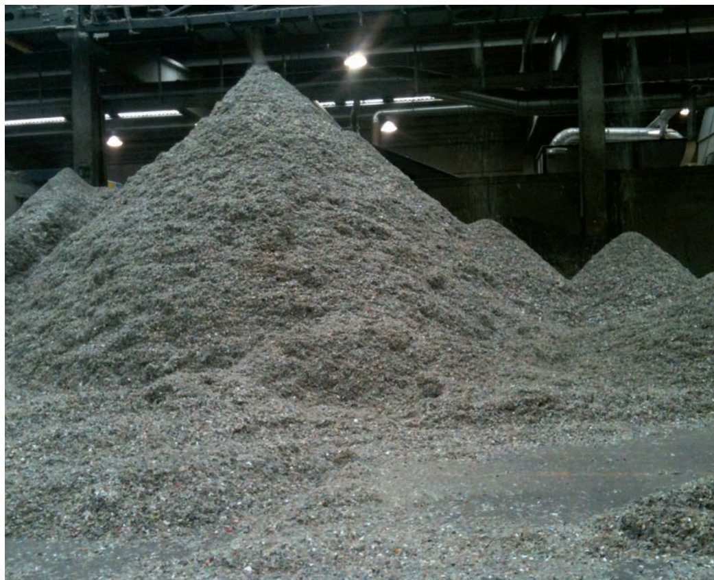
Flusso residuo dai processi di selezione degli imballaggi in plastica, il plamix in alcuni casi ha un elevato contenuto energetico confrontabile con quello del carbone fossile
