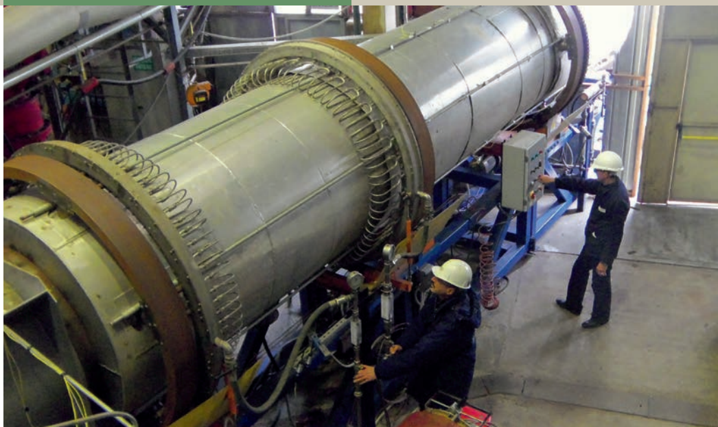
L'impianto pilota è un reattore a tamburo rotante messo a punto da CSM
